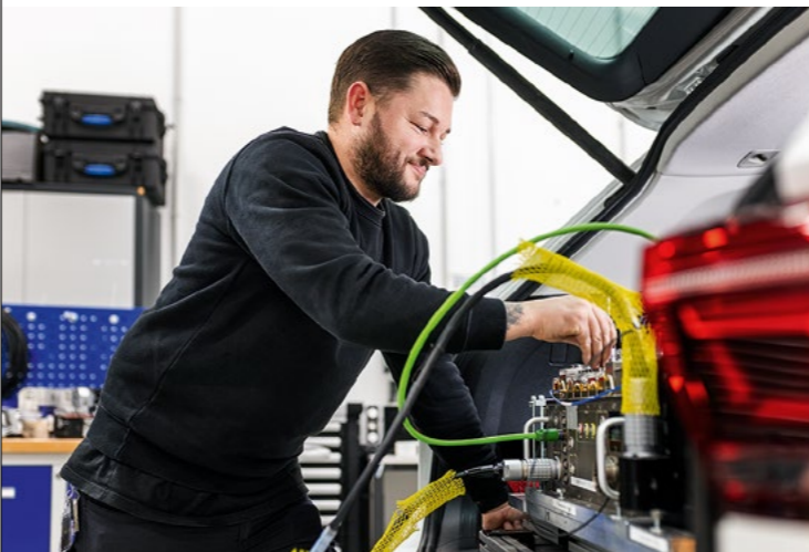
Gründliche Vorbereitung: Selda Gicir und Fabian Pfeifer statten Versuchsfahrzeuge vor dem Crashtest mit komplexer Messtechnik aus.
